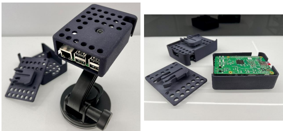
Figura 13: Cámara y placa de control montada con la caja y el soporte de ventosa.
